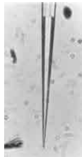
Figura 21.14 Fotografía de un microelectrodo líquido de intercambio de iones para potasio, el cual tiene un intercambiador de iones de 125 \mu\text{m} en la punta. El aumento de la foto original fue de 400X. (Reimpreso con permiso de Anal. Chem. , marzo 1971, 43(3), 89A-93A. Copyright 1971 American Chemical Society.)
