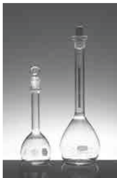
Figura 2.20 Matraces volumétricos típicos.
