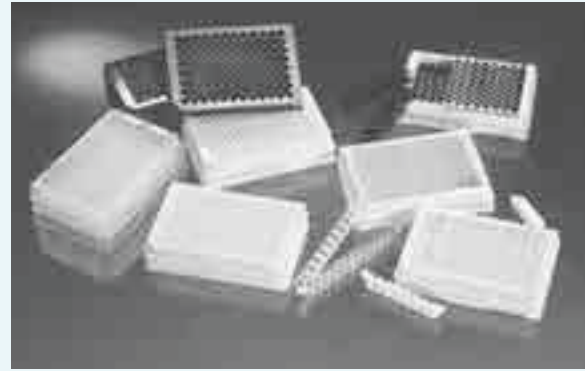
Figura 8A.2 Placas de microtitulación. Existen diferentes tamaños y configuraciones disponibles en el mercado. La mayoría son arreglos de 24 o 96 huecos. Algunas son tiras o pueden ser cortadas en tiras.
