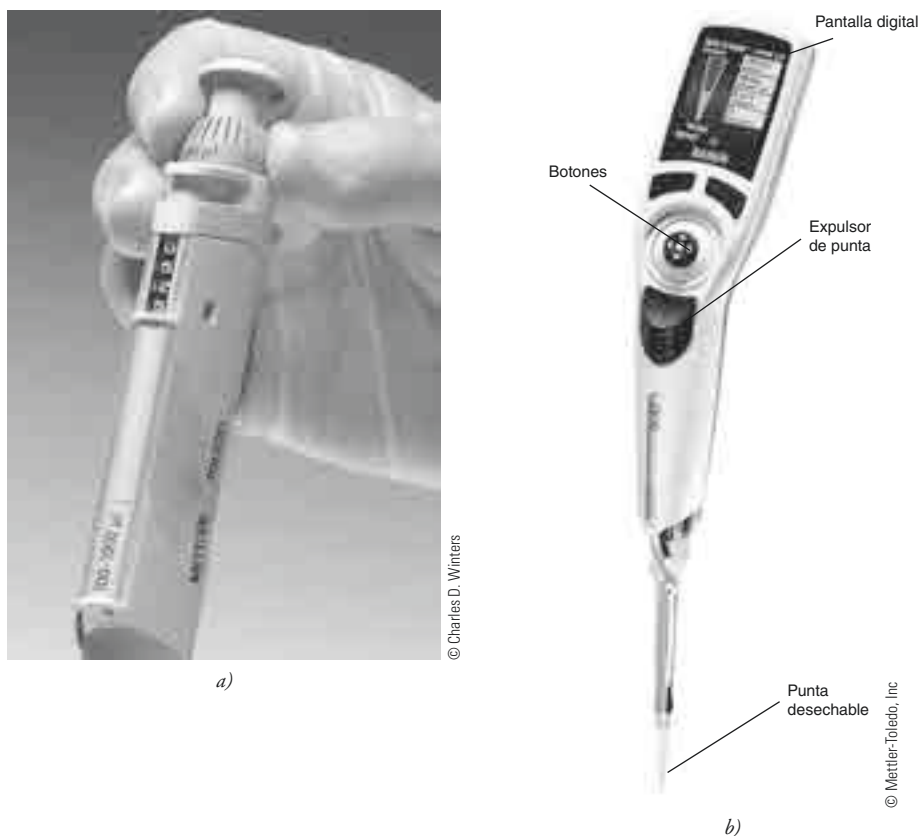
Figura 2.18 a) Pipeta automática de volumen variable, 100–1000 \mu\text{L} . En 100 \mu\text{L} , su exactitud es de 3.0%, y su precisión, de 0.6%. En 1000 \mu\text{L} , su exactitud es de 0.6%, y su precisión, de 0.2%. El volumen se ajusta girando la rueda que se muestra en la imagen. El volumen mostrado es de 525 \mu\text{L} .
