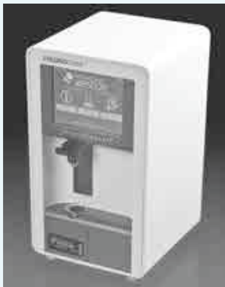
Figura 22A.2 Un clorímetro comercial digital para medir el cloruro. Este titulante coulombimétrico se utiliza para determinar la concentración del ion cloruro en muestras clínicas, en los alimentos y en las muestras ambientales. El punto final se determina mediante un par de electrones que miden la conductividad de la disolución. (Cortesía de Wescor, GMBH, Berlín).
