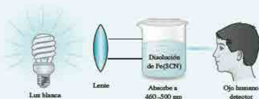
Figura 24A.4 Color de una disolución. La luz blanca de una lámpara o la luz solar inciden sobre una disolución acuosa de \text{Fe}(\text{SCN})^{2+} . El espectro de absorción es bastante amplio pero muestra una absorbancia máxima en el intervalo de 460 a 500 nm (véase la figura 26.4a ). Como consecuencia de la absorción, se transmite el complementario color rojo.
