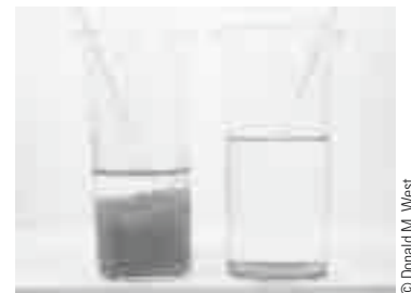
Figura 12.5 Hidróxido de aluminio formado por la adición directa de amoníaco (izquierda) y la producción homogénea de hidróxido (derecha).
