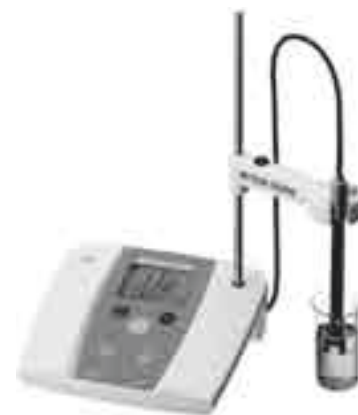
Figura 21.16 Fotografía de un medidor de pH de mesa típico (cortesía de Mettler Toledo, Inc., Columbus, OH).
