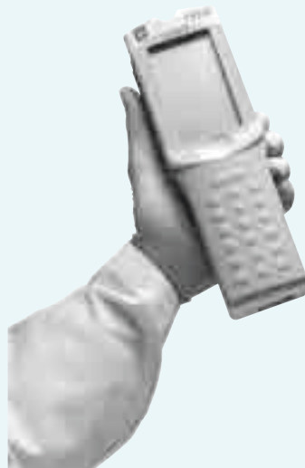
Figura 21A.4 Fotografía del analizador clínico portátil iSTAT 1 (cortesía de Abbott Point of Care, Inc., Princeton, NJ).
