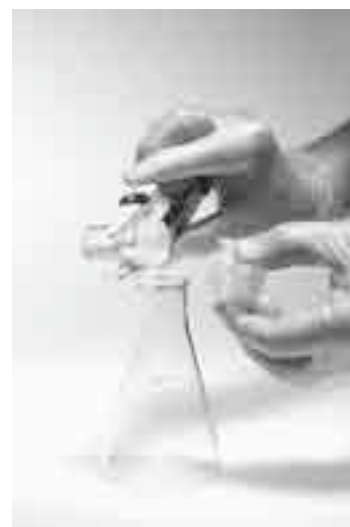
Figura 2.10 Transferencia cuantitativa de una muestra sólida. Observe el uso de pinzas para sostener el frasco para pesar y las tiras de papel para sostener la tapa y evitar el contacto entre el vidrio y la piel.
