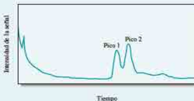
Figura 32A.1 Cromatograma de gases de un extracto de plasma sanguíneo de una víctima de sobredosis de fármacos. El pico 1 corresponde al tiempo de retención apropiado para ser glutetimida, pero el compuesto responsable del pico 2 se desconocía hasta que se realizó la CG/EM.
